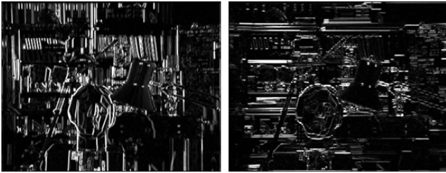
그림 9. 수직 윤곽선 이미지와 수평 윤곽선 이미지 Fig 9. Vertical Edge Image & Horizontal Edge Image
