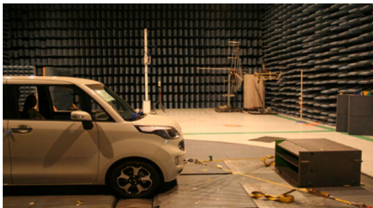
그림 2. 자동차 협대역 시험 장면
