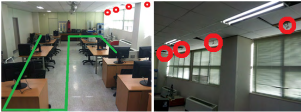
그림 5. 실험장소의 로봇 주행경로와 설치된 USAT A105 비이컨
