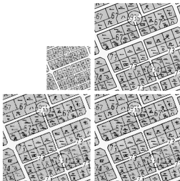
그림 5. Text 영상에 대해서 왼쪽부터 오른쪽으로, 위쪽부터 아래쪽으로 차례대로 저해상도 입력영상, 원본영상, DFDF방식, 제안된 방식.
