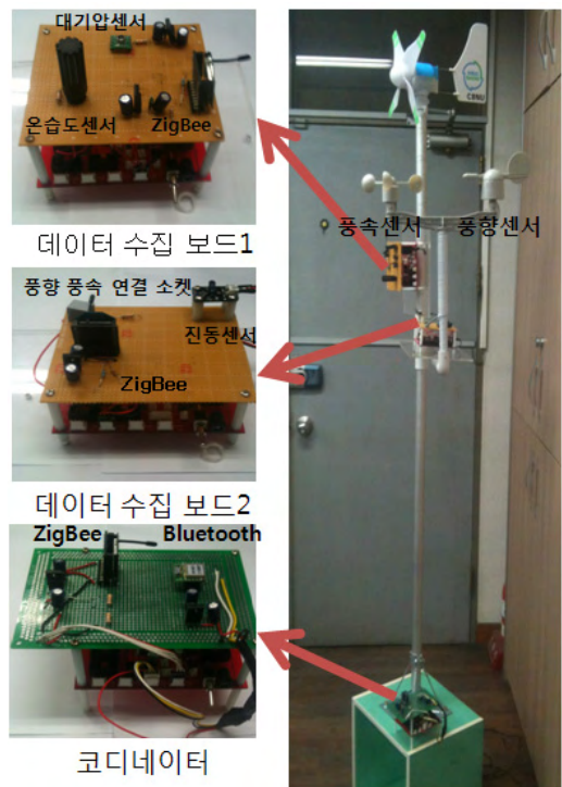
그림 5. 풍력발전기 모니터링 테스트베드
