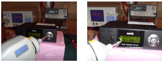
그림 3. 정전기 방전 시험 장면(좌:Air, 우:Contact)
