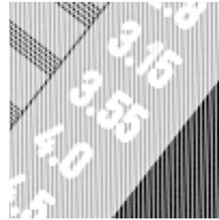
그림 2. 직접 방식 DR 장치를 사용한 디지털 X선 디텍터에서의 그리드 왜곡(DRTECH, FLAATZ 560)
