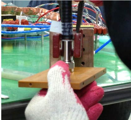
그림 1. 유도가열을 이용한 RF동축케이블과 커넥터 솔더 연결
