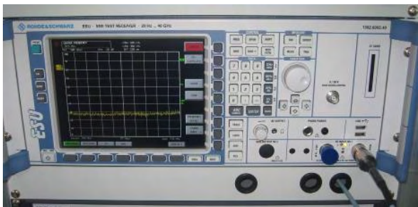
그림 4. 전자파노이즈 측정용 Receiver
