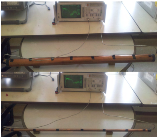
그림 2. 배관의 S-파라미터 측정
