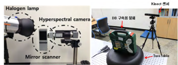
그림 3. 3D 영상 획득 시스템(좌:Kinect, 우:Hyperspectral Camera)
