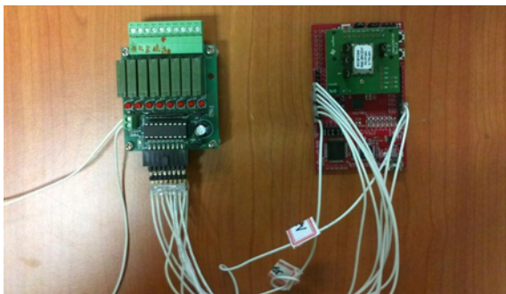
그림 7. Wireless Fan Control Board
