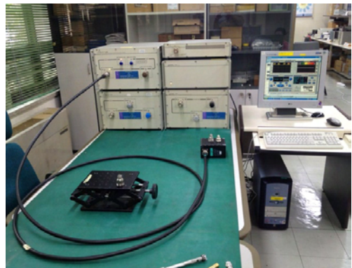
그림 5. PIMD 측정 장치 셋업 (모델 : 서미텍 SI-2000A)
