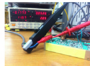
그림 7. 90W 전원장치의 실험 및 파형(부하 2.05W)
