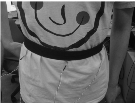
그림 2 벨트에 FSR을 부착하여 Wearable Device 형식으로 제작하고 착용한 모습.
