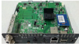
(a) STB의 외형 (b) STB의 내형 그림 7. 스마트TV 2.0 셋탑 박스
