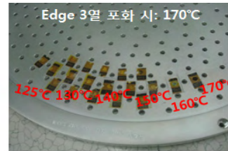
그림 2. Thermal Tape로 측정된 Baffle의 온도
